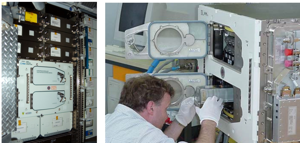
Фиг.1. Апаратурата EMCS: а) Общ изглед; б) Зареждане на експериментален контейнер
